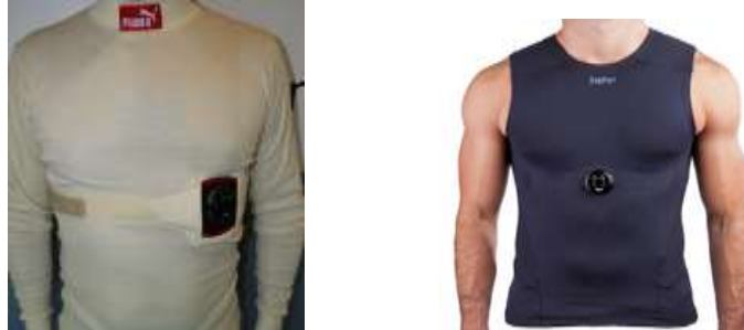
Figura 3: magliette con sensori integrati (due modelli: nella prima la cintura è inserita in una apposita tasca della maglietta , la seconda ha i sensori integrati all'interno con apposito alloggiamento per il BH3)
