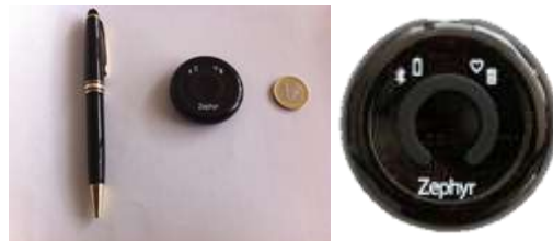
Figura 1: il BH3 è un apparato di dimensioni contenute con un peso di soli 17g
