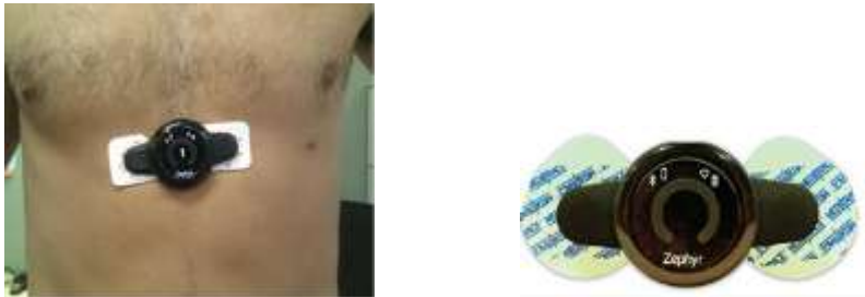
Figura 4::supporto flessibile per il BH3 con attacco per elettrodi adatto per applicazioni cardiologiche
