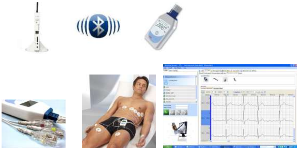
Fig. 9. ECG 12 derivazioni : Il device può essere anche indossato e collegato con comuni elettrodi adesivi e registrato in tempo reale.
