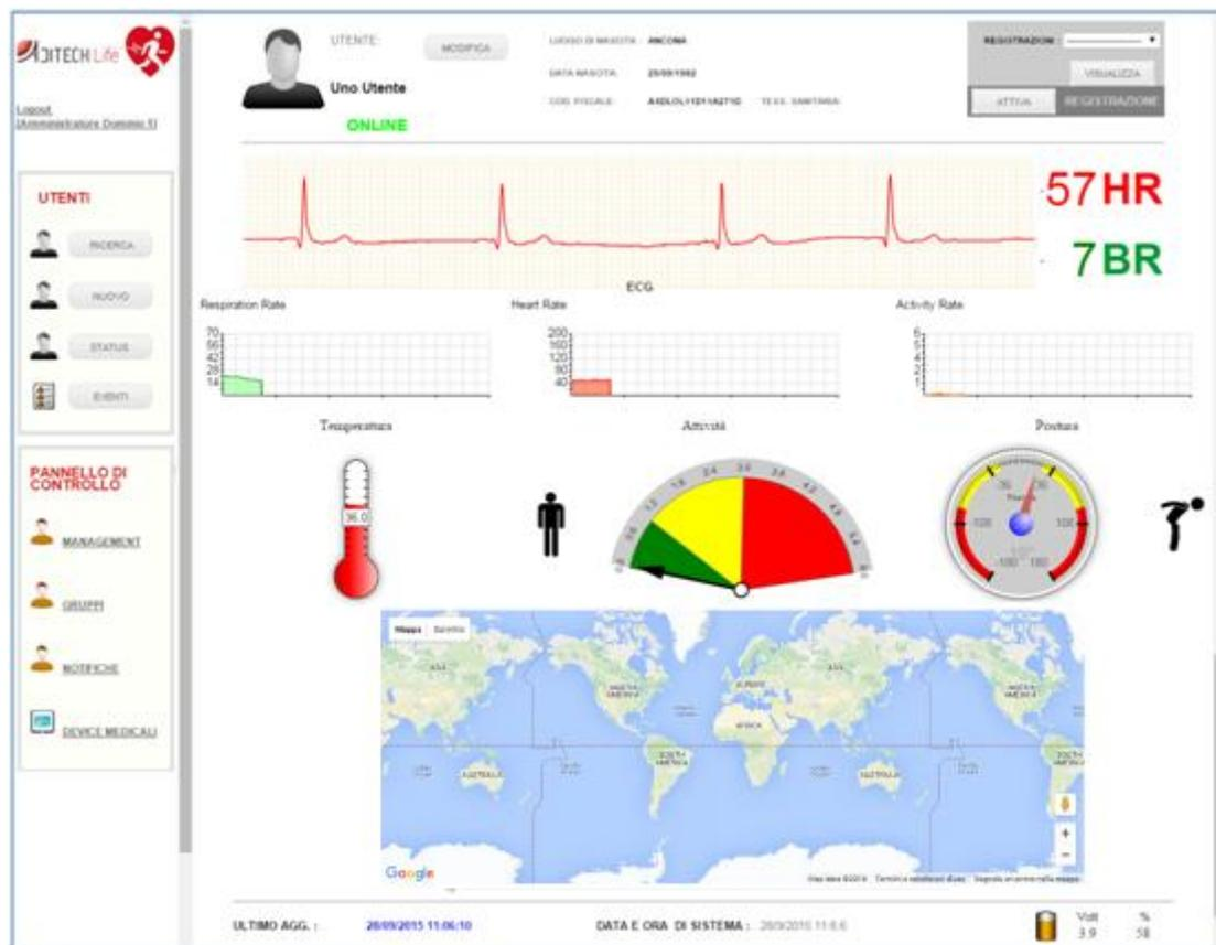
Dato che l'utente sta effettuando una misurazione *Real Time*, la pagina rende possibile visualizzare in diretta tutti i dati istantanei dello stesso, compresa la localizzazione GPS.
