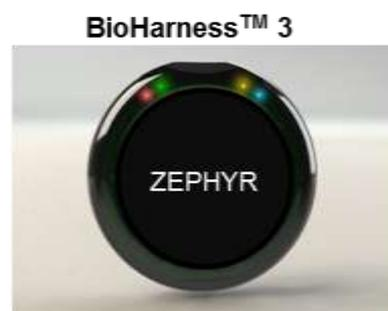
Il sensore, che potremmo definire come un precursore della BSN (body sensor network) in quanto una volta indossato rileva i parametri vitali in modo continuo e non invasivo, trasmette i dati rilevati attraverso una connessione Bluetooth, che può essere ricevuta da un computer dotato di analogo rivelatore oppure da uno smartphone con un apposito software. Quest'ultimo offre un ulteriore vantaggio molto importante
