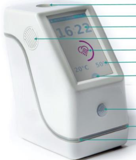
Pulsante di richiesta soccorso Informazioni sistema Orario Altoparlante Pulsante centrale Temperatura e Umidità Pulsante principale «MENU»
